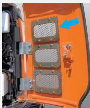
Пылезащитные сетки на капоте (опционные)
