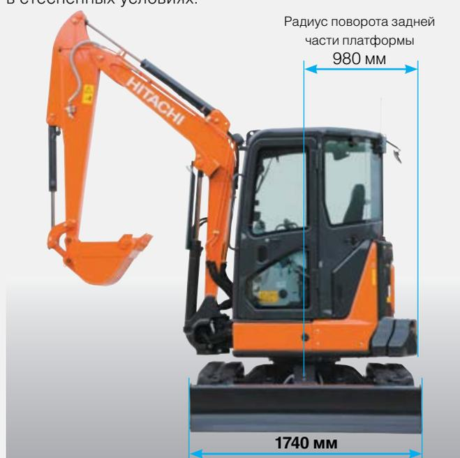
Показан экскаватор в комплектации с рукоятью длиной 1,72 м, трубопроводом для дополнительного навесного оборудования и дополнительным противовесом.
