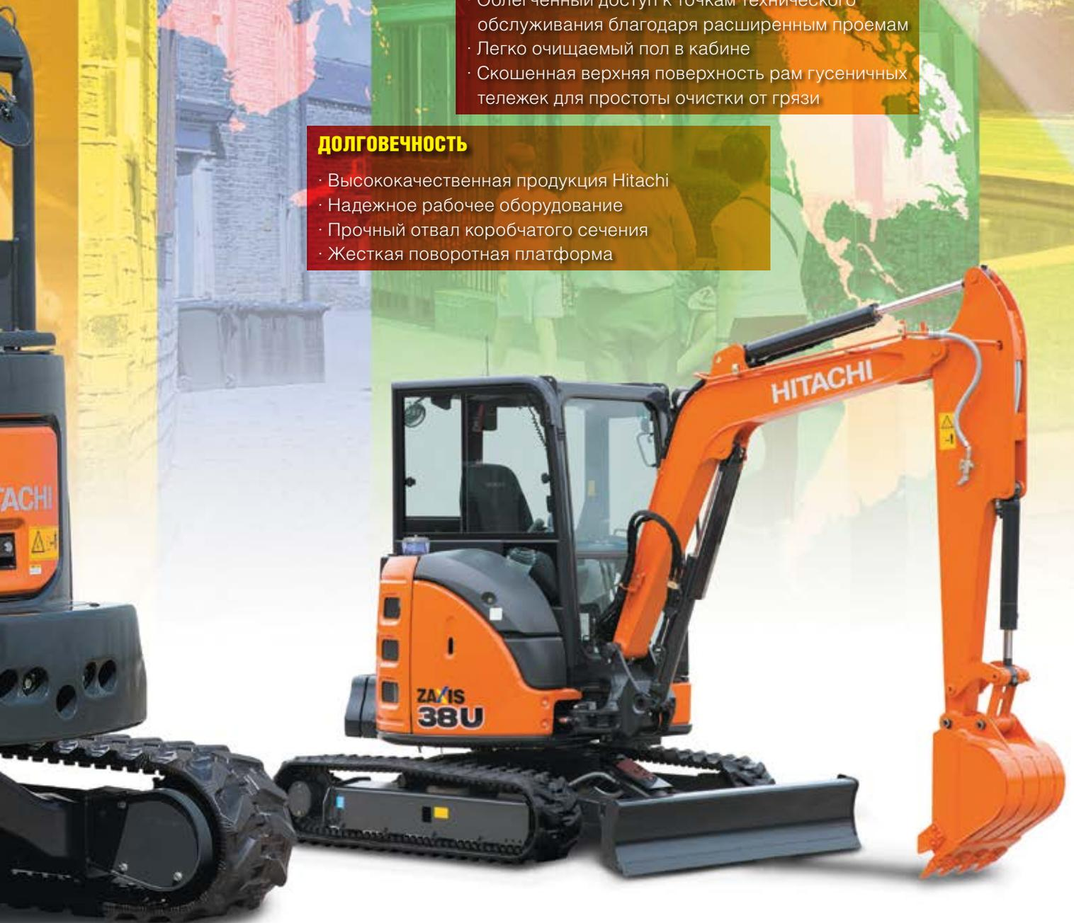
Показан экскаватор в комплектации с рукоятью длиной 1,72 м, трубопроводом для дополнительного навесного оборудования, дополнительным противовесом, зеркалом заднего вида и первичным очистителем воздуха.
