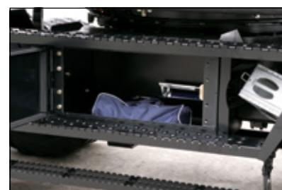
Машина имеет большой инструментальный ящик, достаточный для размещения в нем, например, ведра. Ящик можно использовать для хранения любых инструментов и шприцев для смазки.
