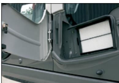
Воздушный фильтр наружного воздуха кондиционера расположен со стороны двери кабины, а не традиционно – за креслом оператора. Это позволяет легко чистить и менять воздушный фильтр наружного воздуха, а также фильтр системы рециркуляции воздуха в кабине.
