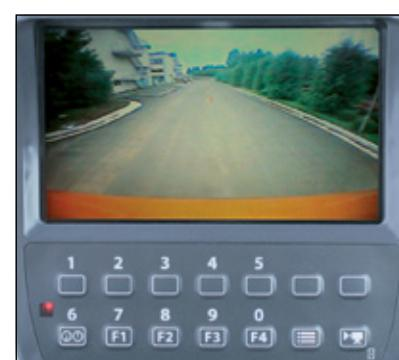
Широкоэкранный цветной ЖК-монитор, подключенный к расположенной на противовесе камере заднего вида, обеспечивает обзор сзади. Камера заднего вида автоматически работает во время заднего хода, а также может быть повернута вручную с помощью переключателя на мониторе.
