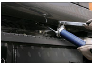
Конструкция отверстия для смазки опорно-поворотного круга была модернизирована; отверстие располагается теперь под кабиной. Это облегчает процесс смазки и проведение технического обслуживания.
