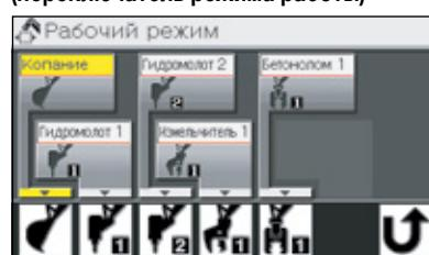
При замене навесного оборудования регулировку потока масла можно выполнить автоматически, одним нажатием на переключатель режима работы на дисплее ЖК-монитора. При необходимости можно осуществить незначительную корректировку потока масла.
