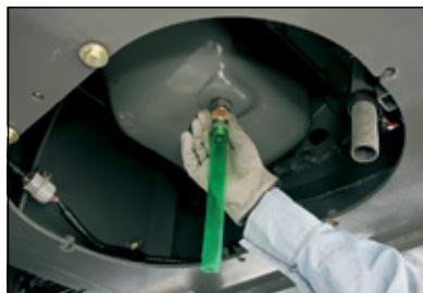
Масляный поддон двигателя оснащен сливным патрубком. При сливе к патрубку подключается сливной шланг. Сливной патрубок надежен, предотвращает утечку масла и умышленную порчу.
