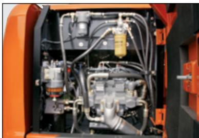
Широкие двери обеспечивают доступ к топливному фильтру, водоотделителю и фильтру моторного масла с уровня земли. Гидравлическое масло может использоваться до 5 000 часов.
