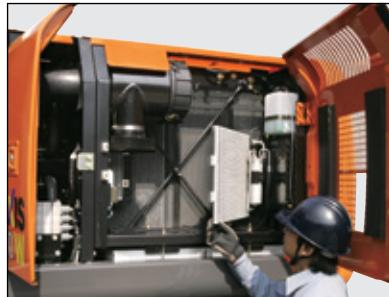
Маслоохладитель, радиатор и промежуточный охладитель расположены параллельно, а не последовательно, как в традиционной компоновке. Такая параллельная компоновка значительно облегчает очистку пространства вокруг двигателя. Конденсатор воздушного кондиционера можно открыть, что облегчает очистку самого конденсатора, а также расположенного за ним радиатора.
