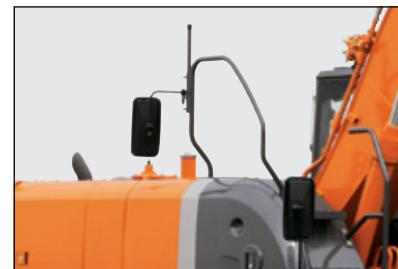
К моторному отсеку ведут большие поручни, ступеньки и противоскользящие пластины.
