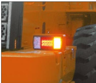
Задние габаритные фонари оснащены светодиодными лампами, характеризующимися высокой яркостью освещения и долгим сроком службы.
