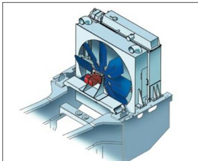
Скорость вращения вентилятора системы охлаждения с гидроприводом зависит от рабочей температуры агрегатов, что ведет к снижению уровня шума и расхода топлива.
