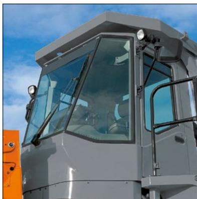
Внутреннее и наружные зеркала заднего вида обеспечивают отличный обзор пространства вокруг машины. Переднее окно оснащено плоским стеклом, которое крепится при помощи резиновых уплотнений и может быть легко заменено. Кабина установлена на вязкостных амортизирующих опорах, которые прекрасно поглощают удары и понижают уровень шума, создавая комфортные условия работы оператора.
