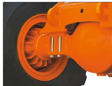
Наружные герметичные дисковые тормоза мокрого типа развивают значительное тормозное усилие и отлично противостоят загрязнению. Два независимых контура для тормозов переднего и заднего мостов повышают уровень безопасности при эксплуатации машины.
