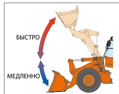
Эта система повышает тяговое усилие на этапе копания при одновременном снижении расхода топлива. Это позволяет достичь повышенной производительности при сниженном расходе топлива.
