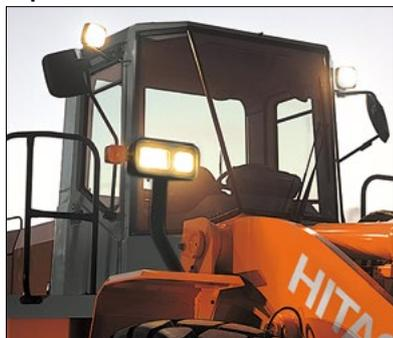
В передних и задних фонарях рабочего освещения используются яркие галогенные лампы, гарантирующие безопасную работу во время ночных смен.
