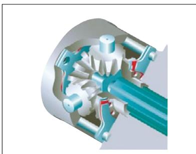
Дифференциал такой конструкции эффективно передает высокое тяговое усилие в зависимости от конкретных рабочих условий.
