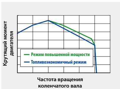
Для двигателя предусмотрено два режима работы: повышенной мощности и топливозономичный. Режим повышенной мощности позволяет машине работать с более высокой производительностью, в то время как топливозономичный режим позволяет снизить расход топлива.
