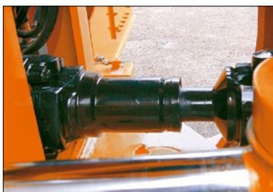
Герметичные шарниры необходимо смазывать через каждые 12 000 мото-часов. Это упрощает техническое обслуживание машины и продлевает срок ее службы.
