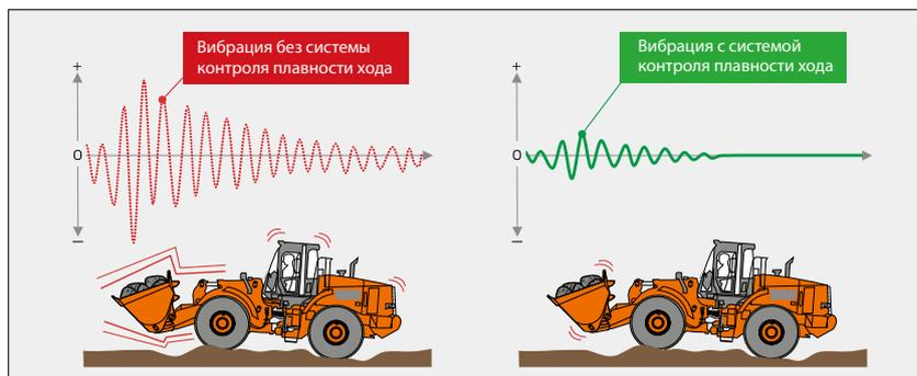
Система контроля плавности хода уменьшает продольные и поперечные колебания стрелы при движении по пересеченной местности и заснеженным дорогам. Она автоматически контролирует раскачивание рабочего оборудования для снижения ударных нагрузок и вибрации.
