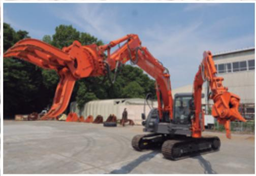
Экскаватор ASTACO с двумя стрелами для комплексной эксплуатации
