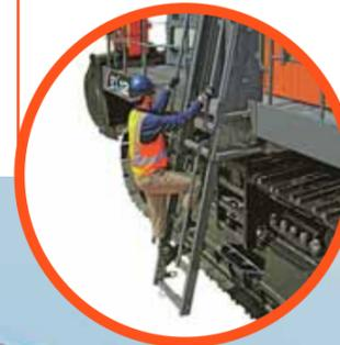
**Безопасность** Раздвижная лестница и широкие боковые проходы с противоскользящим покрытием обеспечивают безопасный доступ к ботам.
