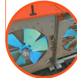
**Производительность** Вентиляторы радиатора и охлаждающие вентиляторы могут работать в обратном направлении, обеспечивая удаление пыли, уменьшая степень загрязнения радиатора.
