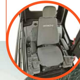
**Комфорт** Кабина опирается на 6 опор, заполненных жидкостью, что снижает воздействие вибрации. Сиденье с пневмоподвеской регулируется подвеской оператора.
