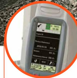
**Комфорт** Светодиодный многофункциональный дисплей информирует о ключевых параметрах шины, рабочих часах тележки, плановом обслуживании и рекомендациях по ремонту.
