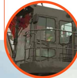
**Комфорт** Увеличена толщина стекла кабины с 4 мм до 8,8 мм, снижен уровень шума в кабине, тонировка стекла снижает утомляемость оператора.
