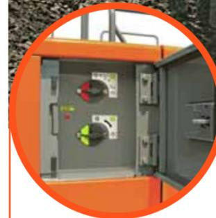
**Безопасность** Двойной изолирующий выключатель одновременно отключает стартер двигателя и аккумуляторную батарею, обеспечивая безопасность при проведении сервисных работ.
