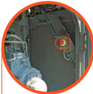
**Безопасность** Кнопка остановки двигателя в несомкнутой секции и в кабине позволяет заблокировать запуск двигателя в экстренной ситуации.
