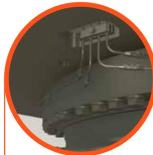
**Надежность** В EX1200-7 используется ковкий поворотный подшипник, который пришел из меню литому элементу, также увеличена толщина верхней плиты (до 55 мм), что позволило увеличить прочность и долговечность рамы.
