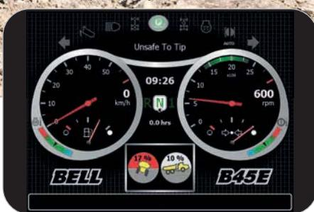
Наличие датчика уклона и крена не позволяет поднимать кузов, если самосвал находится в опасном положении.
