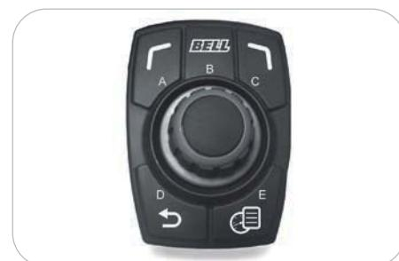
Автомобильный контроллер с навигационным меню на цветном мониторе позволяет получить информацию по машине и внести изменения в настройки.
