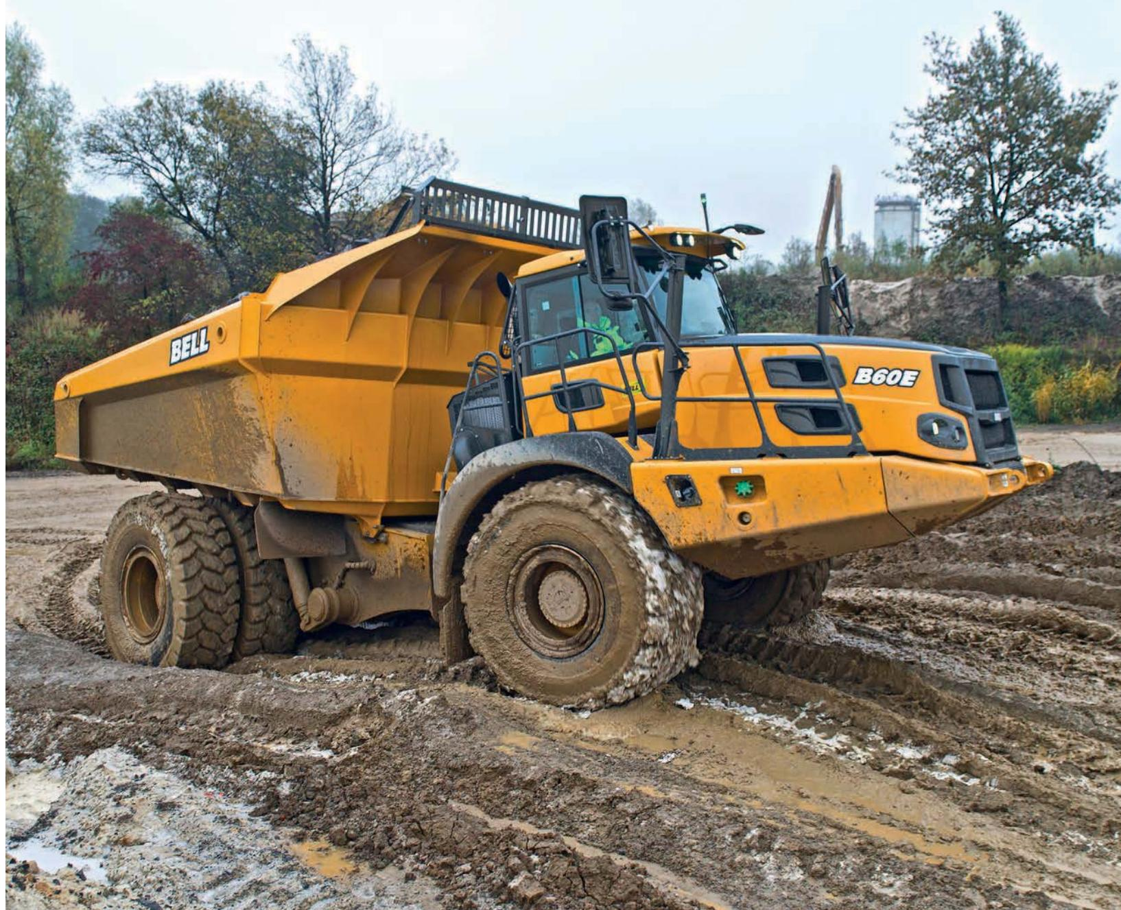
• Шарнирно-сочлененная рама между передним и задним шасси обеспечивает намного более крутые радиусы поворота, чем мост с управляемыми колесами, и делает B60E идеальной машиной для стесненных рабочих площадок.
