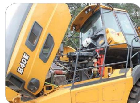
Кабину можно наклонить без применения специализированных инструментов.
