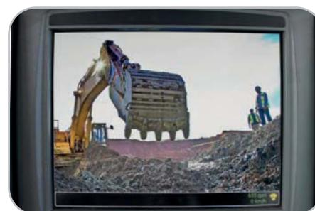
Опционально добавленная камера заднего вида позволит еще больше увеличить обзор в кабине водителя.
