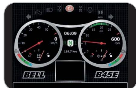
Удобный в пользовании 10-дюймовый цветной монитор отображает основную рабочую информацию, предупреждения об осторожности, подробные диагностические показания и функциональные настройки кузова самосвала.
