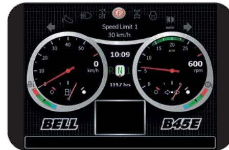
Управление максимальной скоростью может осуществляться водителем в зависимости от участка работы, что позволяет автомобилю автоматически замедлить ход и включить тормоз-замедлитель для предотвращения превышения скорости на рабочем участке. Также можно настроить ограничение скорости в зависимости от перегрузки.
