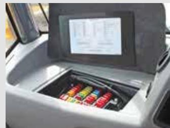
Размещенный в кабине электрический блок упрощает процесс замены плавких предохранителей. Меньшее количество реле, соединителей и электропроводки обеспечивает большую надежность.
