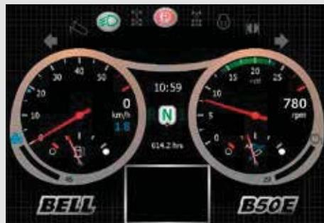
Удобный в пользовании 10-дюймовый цветной монитор отображает основную рабочую информацию, предупреждения об осторожности, подробные диагностические показания и функциональные настройки кузова самосвала.
