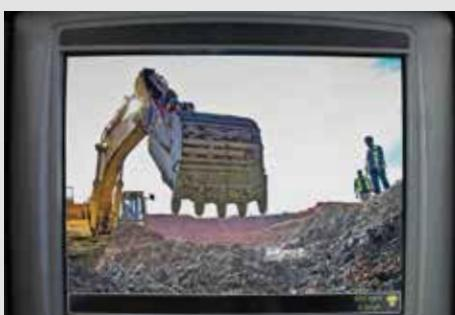
Опционально добавленная камера заднего вида позволит еще больше увеличить обзор в кабине водителя.
