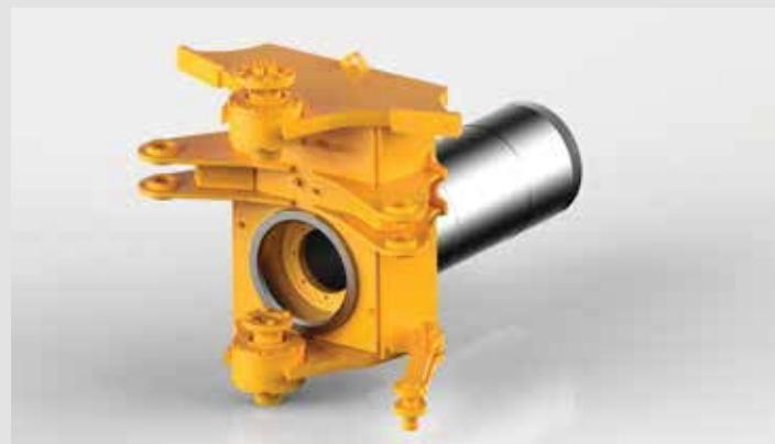
Поворотный шарнир лежит в основе решения самосвала с шарнирно-сочлененной рамой. Он удерживает колеса на земле, обеспечивая сцепление при езде по неровной местности. B60E унаследовал поворотный шарнир от B50E, который был надлежащим образом усилен.
