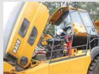
Кабину можно наклонить без применения специализированных инструментов.
