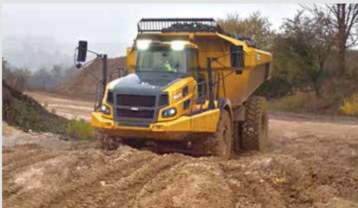
Если настроить карданныю передачу на прямой привод на все колеса, Bell B60E может проехать там, где обычные грузовики не смогут.
