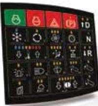
Удобный модуль герметичных кнопок предоставляет возможность контактного управления многочисленными функциями, увеличивающими производительность, одним нажатием в т.ч. запуск двигателя без ключа, I-Tip, регулировка ограничения угла поднятия кузова, выбор мягкой/жесткой остановки, настройка интенсивности работы замедлителя и переключения скоростей.
