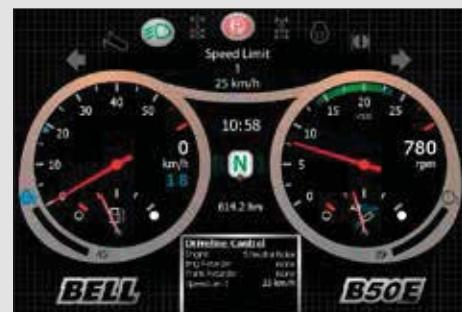
Опция бортовых весов позволяет водителю получать информацию в режиме реального времени о полезной нагрузке в процессе загрузки машины. Функция «ограничения скорости» может быть активирована, если машина излишне перегружена.
