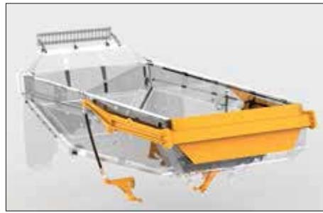
Задний откидной борт позволяет удерживать большее количество перевозимого материала. Он открывается при подъеме кузова для разгрузки. Тяги из пружинной стали обеспечивают плотное закрытие в ходе перевозки, обеспечивая минимальную потерю перевозимого материала.
