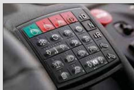
Запуск машины без ключа. Идентификатор водителя и коды доступа исключают несанкционированную эксплуатацию оборудования.
