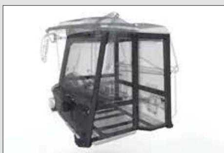
Наши операторские кабины с отличной звукоизоляцией, сертифицированной защитой от опрокидывания (ROPS) и защищают от падающих предметов (FOPS) оборудованы сидениями на пневмоподвеске. Сидение инструктора оснащено 2-точечным, а сидение оператора – 3-точечным ремнем безопасности с автоматическим защелкивающимся механизмом.
