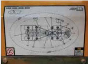
Интуитивно понятные наклейки с инструкциями по техническому обслуживанию самосвала (например: смазка).
