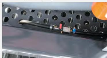
Кран для слива отстоя из топливного бака
