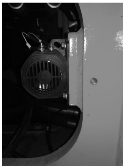
Рисунок 57 Гудок предупредительной сигнализации о движение задним ходом (задний щиток снят)
