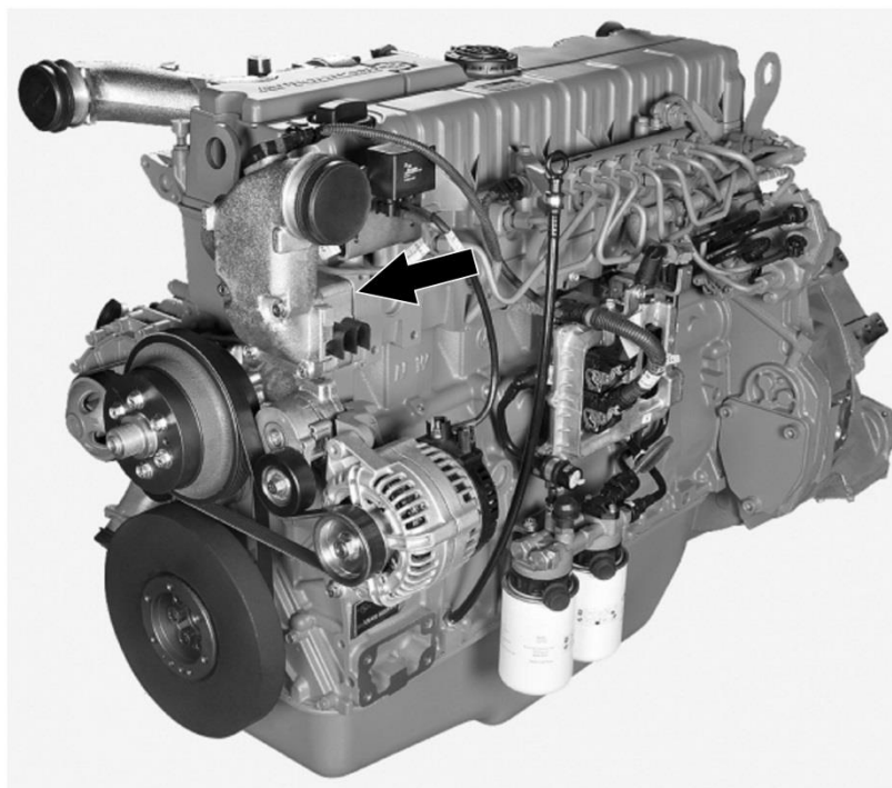
Рисунок 148 Места установки теплоэлемента для облегчения пуска двигателя
