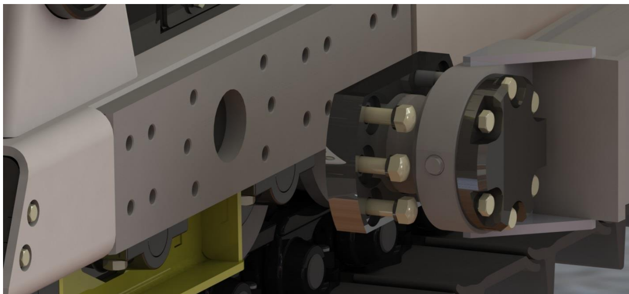
Рисунок 84 Монтаж брусьев на раму
