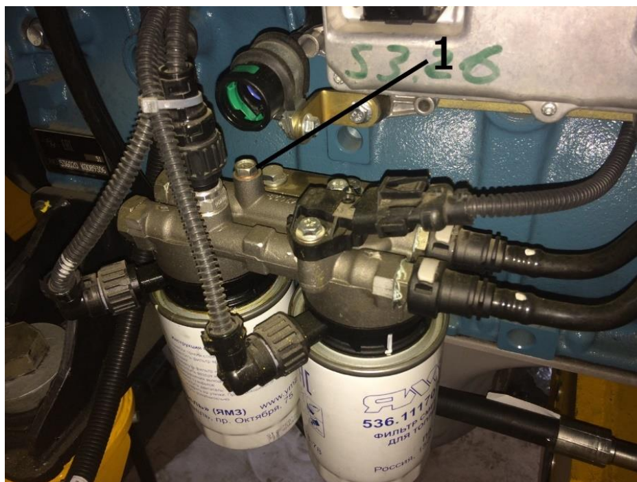
Рисунок 165 Удаление воздуха из топливных фильтров тонкой очистки
