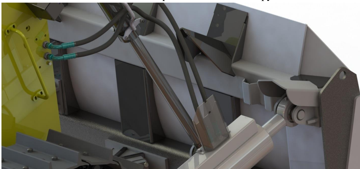
Рисунок 89 Монтаж гидролиний перекоса отвала
