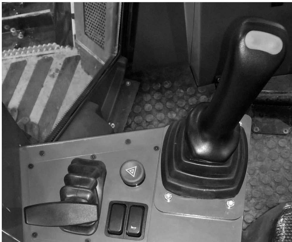
Рисунок 67 Рычаг управления гусеничным ходом в нейтральном положении
