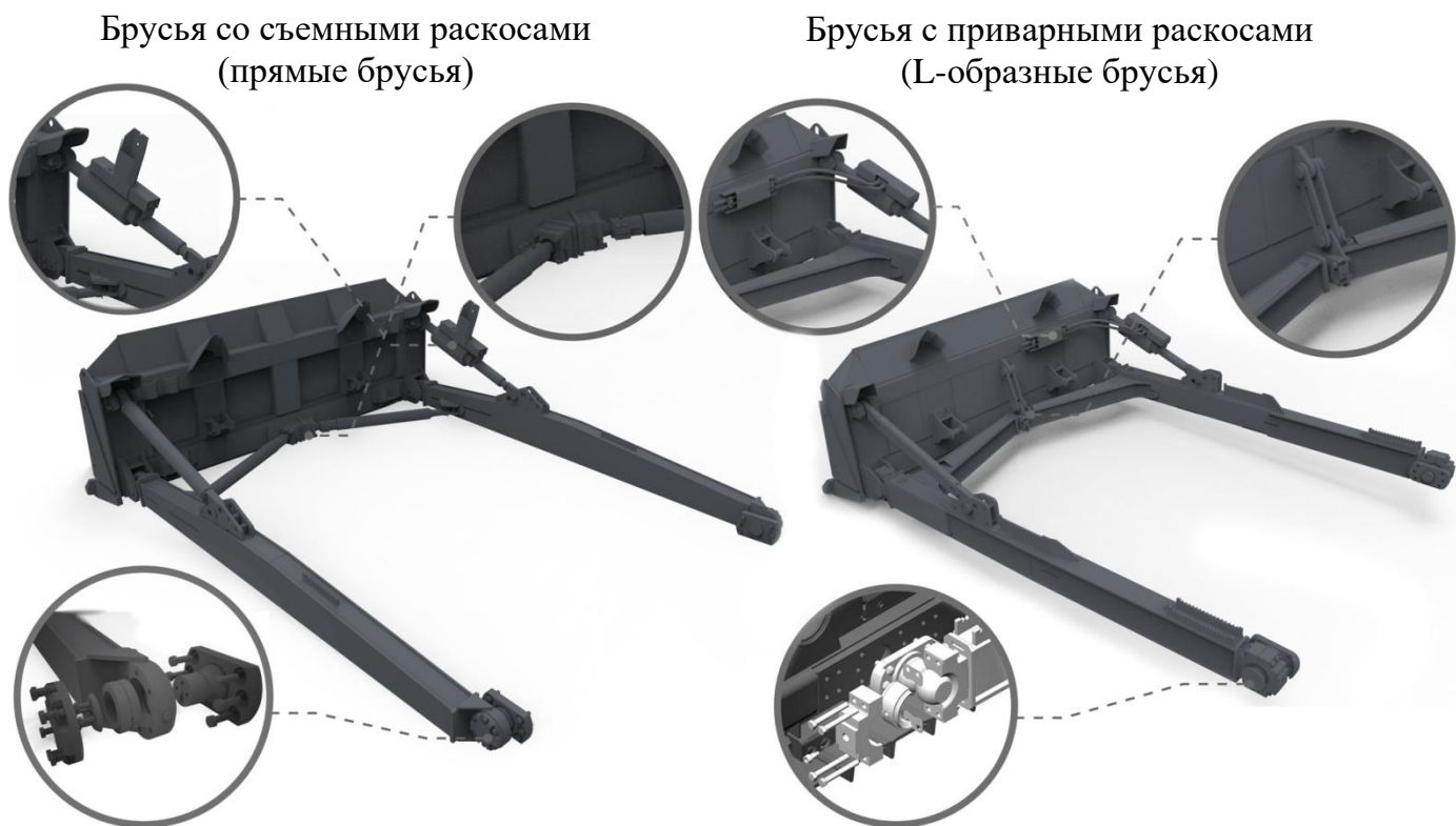
Рисунок 83 Отличия отвалов съемными и приварными раскосами
