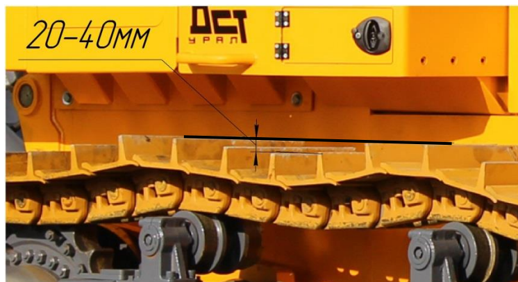
Рисунок 204 Проверка натяжения гусениц
