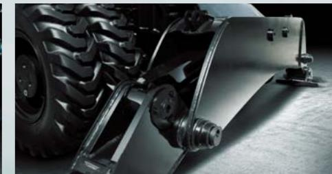
Усиленная защита гидроцилиндов выносных опор
