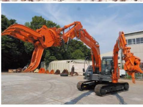
Экскаватор ASTACO с двумя стрелами для комплексной работы
