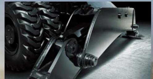
Усиленная защита гидроцилиндров выносных опор
