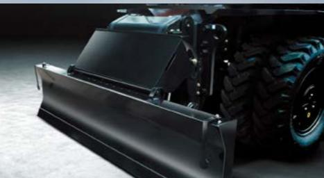
Полная защита гидроцилиндра отвала
