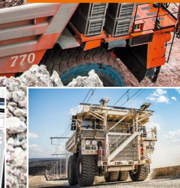
Система тягового электропривода переменного тока повышает производительность
