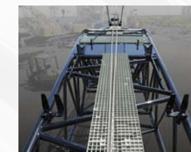
Расширенные монтажные мостики (выполнены из стекловолокна) ДОПОЛНИТЕЛЬНОЕ ОБОРУДОВАНИЕ
