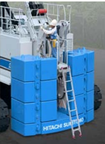
Функция QuickDraw — гарантия быстрой сборки и демонтажа рамы шасси
